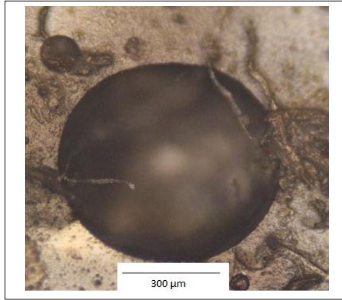
شكل (24) أثر الانهيار الكهربائي للنموذج (Ep, t=1.5mm) بقوة تكبير (100X)
