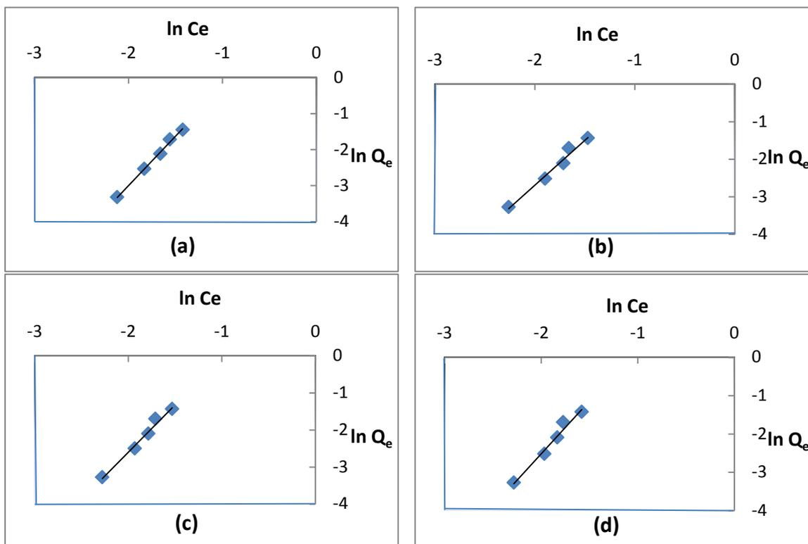
Fig. (8): Plot of Freundlich adsorption isotherms of BG on Fe-BNC [(a) 283, (b) 293, (c) 298, (d) 303K]
